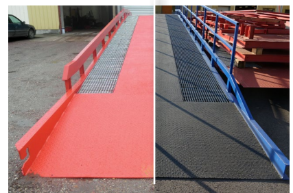
Rampe (6 tonnes) munie d'une bande de roulement en tôle larmée pour le passage des transpalettes électriques sur photo de gauche. Atténuation de bruit par application d'une résine sur photo de droite
