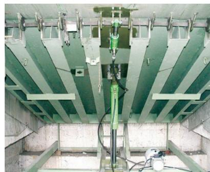
Si vos anciens niveleurs mécaniques sont encore en bon état (châssis, plate-forme, lèvre d'appui), nous pouvons les transformer en niveleurs hydrauliques équipés de toutes les sécurités (normes CE).
